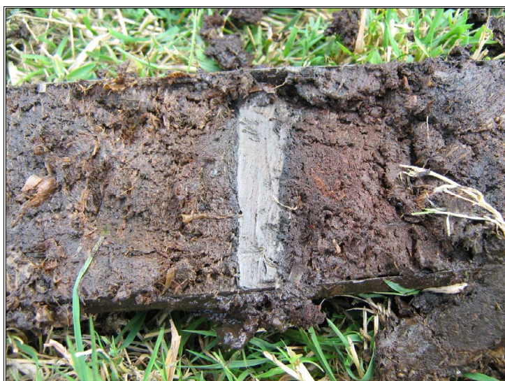
Figuur 14: Een gats-boring uit het onderzoeksgebied met een fijngelaagde kleilaag
